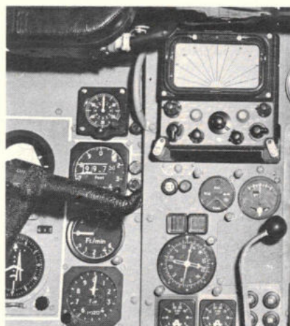
Afb. 59 Weer-radar in de „Trident” (UK) verkeersmachine. Bediening en presentatie-eenheid is niet veel groter dan een universele meter.
